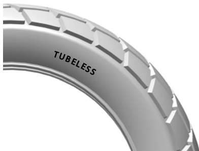
Типичная маркировка шин — бескамерные шины
