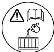
Для обеспечения эффективного охлаждения двигателя проверяйте уровень охлаждающей жидкости каждый день перед поездкой и доливайте охлаждающую жидкость, если ее уровень недостаточен.
