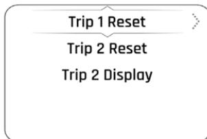
Выбор TRIP 1 RESET [СБРОС ПРОБЕГА 1] или TRIP 2 RESET [СБРОС ПРОБЕГА 2] позволяет конфигурировать соответствующий счетчик пробега в ручном или автоматическом режиме. Процедура настройки одинакова для обоих счетчиков пройденного пути.
