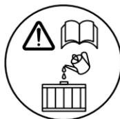
Для обеспечения эффективного охлаждения двигателя проверяйте уровень охлаждающей жидкости каждый день перед поездкой и доливайте охлаждающую жидкость, если ее уровень недостаточен.
