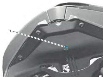
1. Регулировочный винт фары (на фото — Tiger Sport 660)
