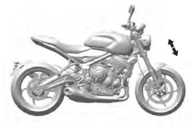
Проверка передней вилки (на примере Trident 660)
