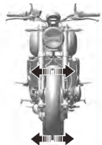
Проверка подшипников колес (на примере Trident 660)
